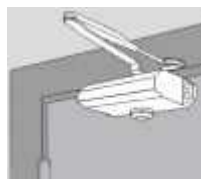
Установка со стороны петель на дверном полотне
